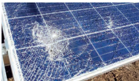
Photo 26 : Panneau photovoltaïque endommagé (© Andrei Merkulov/AdobeStock)
