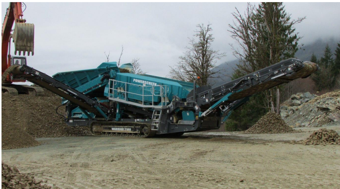
Illustration n° 24 : Installation de criblage
