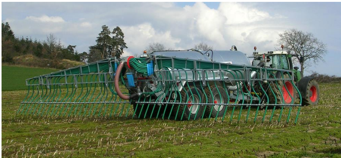
FIGURE 17: EXEMPLE DE CHANTIER D'EPANDAGE PAR TONNE A LISIER AVEC PENDILLARDS
