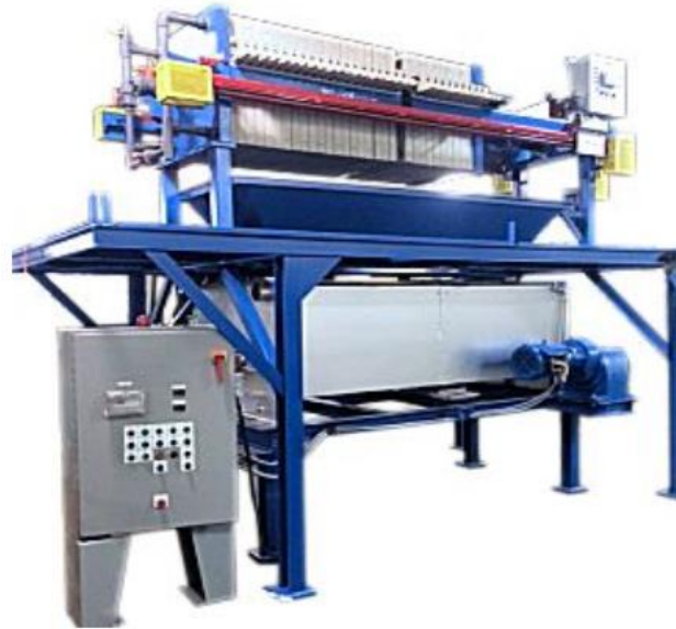
Fig. 111. Photographie d'un filtre presse avec système de séchage des boues
