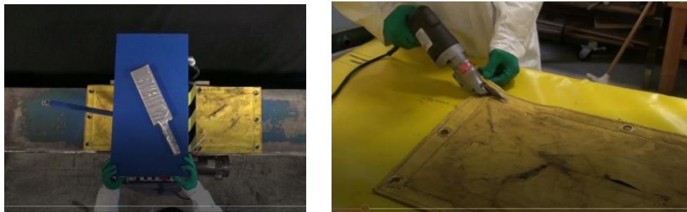
Fig. 27. Pressage, découpe des bords pour récupération de l'enveloppe intérieure
