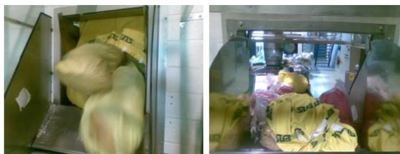
Fig. 13. Déversement des colis de linge sur le convoyeur de la chaîne de tri (Source : UNITECH Services, 2015)
