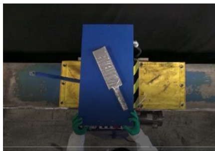
Fig. 26. Pressage, découpe des bords pour récupération de l'enveloppe intérieure
