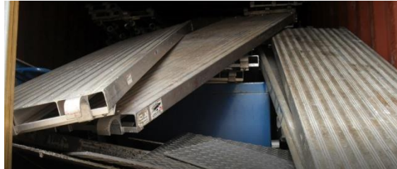
Fig. 21. Container de plate-formes d'échafaudages
