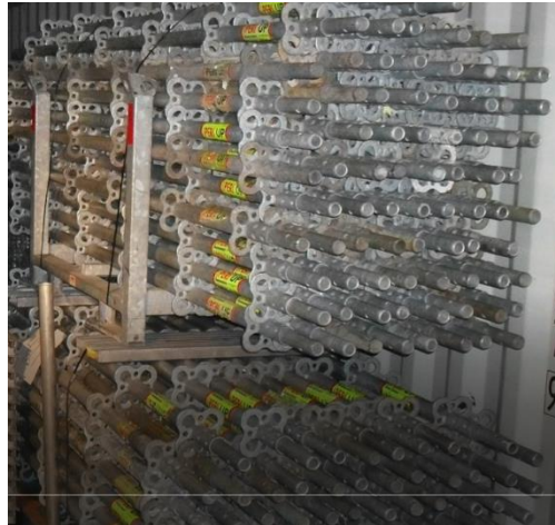
Fig. 24. Container de pièces d'échafaudages nettoyées
